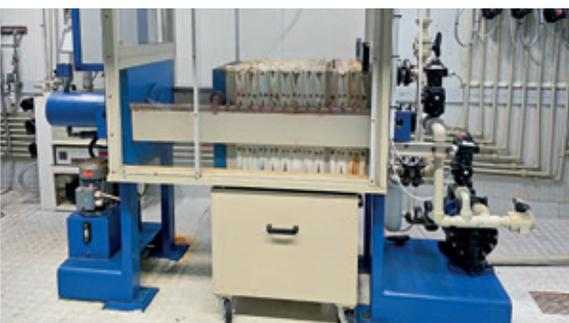
Impianti pilota Fenix per il recupero di rame e metalli preziosi da e-waste
